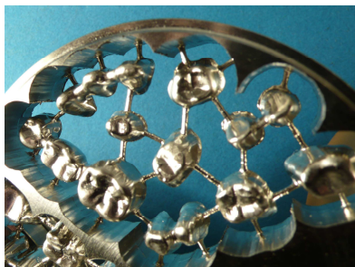
Effektive Bearbeitung des Materials bis zum Rand durch Radialspannung
