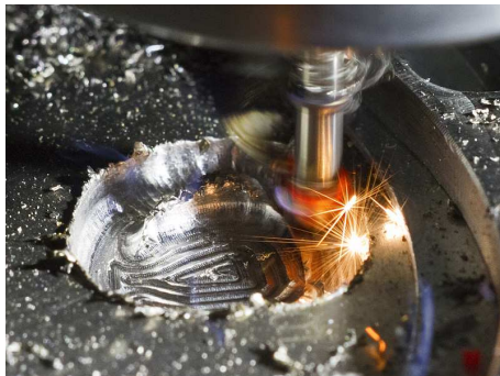
Funkenschlag und Wärmebildung beim Fräsen von Titan Blanks ohne Kühlung
