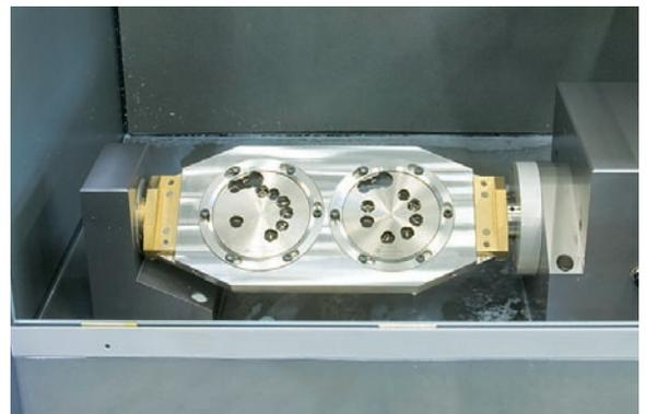
Abb. 9: Der Rohlingshalter der GAMMA 303 und 605 kann zwei Rohlinge aufnehmen.
