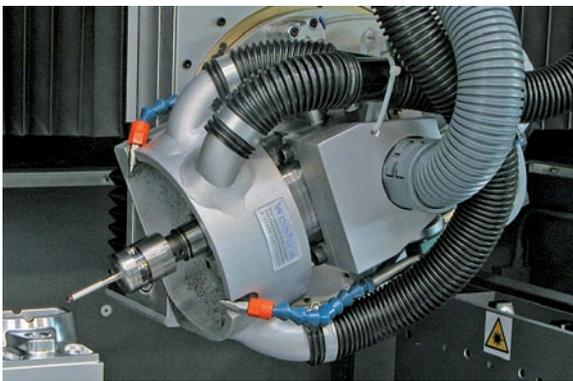
Abb. 6: Für die Nassbearbeitung sind seitlich am Spindelträger Düsen platziert.
