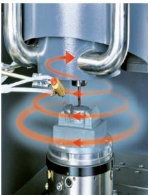
Abb. 7: Bei der Trockenbearbeitung kommt eine patentierte Tornado-Ab-saugung zum Einsatz.
